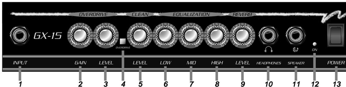
**1: ENTRADA (INPUT):** Conecte su guitarra aquí utilizando en cable blindado para instrumentos.
